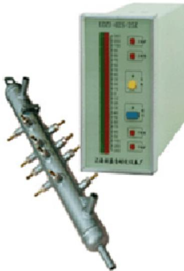
双色电接点液位计突出的优点是能适应锅炉变参数运行, 在锅炉启停等变参数运行工况下。仪表均能在控制室内准确地显示水位。由于它的水位容器截面积较大、水柱的温降所引起的冷却误差远比云母(玻璃)水位计小。电接点液位计的水容器离汽鼓很近、电接点至二次仪表又全是电信号传送, 故本仪表不仅时延小, 而且无机械传动所产生的变差和刻度误差, 不需要进行误差计算和调整。不需要复杂的校验装置, 使仪表检修、校验大为简化, 电接点液位计构造简单、体积小, 并省去了笨重的差压计、传压导管和阀门, 减少了金属消耗量、减轻了工人的检修劳动强度。
