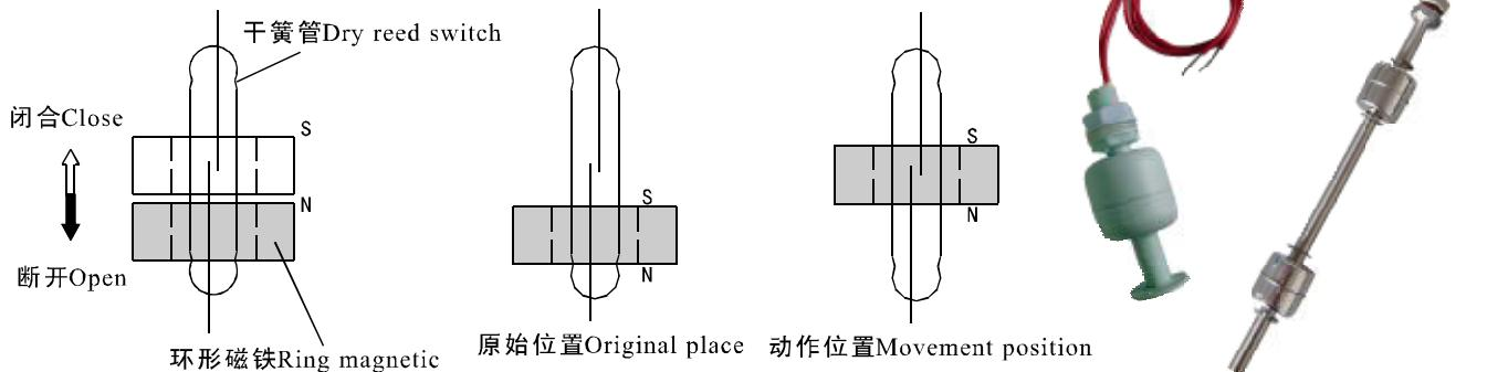
在密闭的非导磁性管内安装有一个或多个干簧管，然后将此管穿过一个或多个且内部有环形磁铁的浮球的孔内，液体的上升或下降将带动浮球一起上下移动，非导磁性管内的干簧管产生吸合或断开的动作，从而输出一个开关量信号（如上图所示）。
